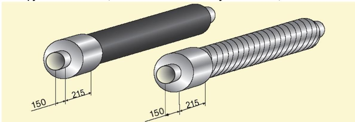
**Пример заказной спецификации** трубы стальной наружным диаметром 426 мм, толщиной стенки 7 мм, с изоляцией типа 1 из пенополиуретана в полиэтиленовой оболочке с металлической заглушкой изоляции длиной 215 мм:
